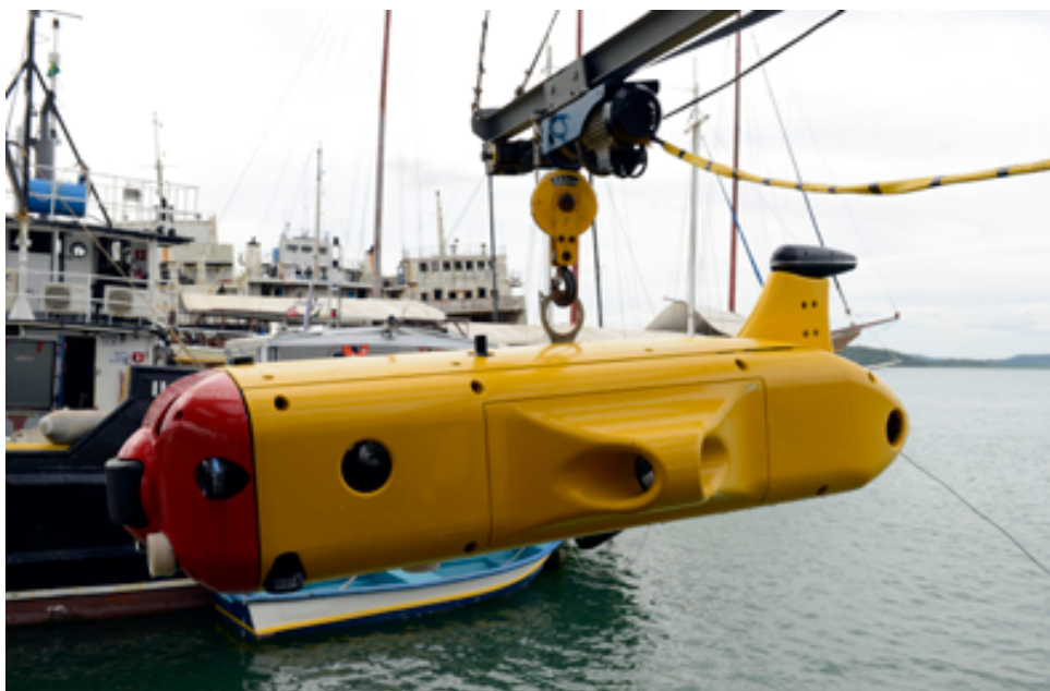
◀ Fruto da parceria da Shell com o SENAI Cimatic, na Bahia, o FlatFish é um avançado veículo autônomo capaz de inspecionar, em 3D, estruturas de exploração submarina de petróleo F: Miguel Ângelo/CNI
